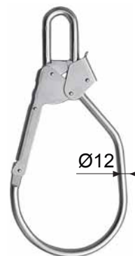
5266AZ025 acier zingué GRANDE OUVERTURE verrouillage automatique double-action ouverture 83mm 330 x 155mm, 820 gr. Résistance 20kN (2039kg)
