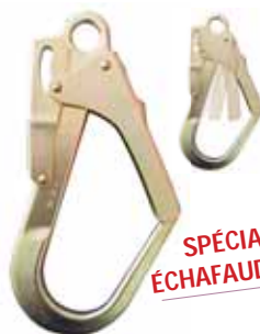
3805C acier zingué à verrouillage automatique double-action ouverture 55mm 214 x 127mm, 510 gr. Résistance 23kN (2345kg)
