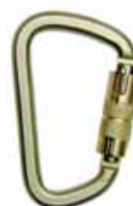
3805B acier zingué 113 x 72mm, 208 gr. Résistance : 20kN (2039kg)
