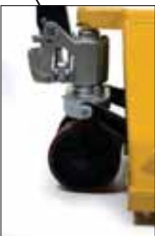
Roue directrice en polyuréthane Roues de fourches doubles polyuréthane
